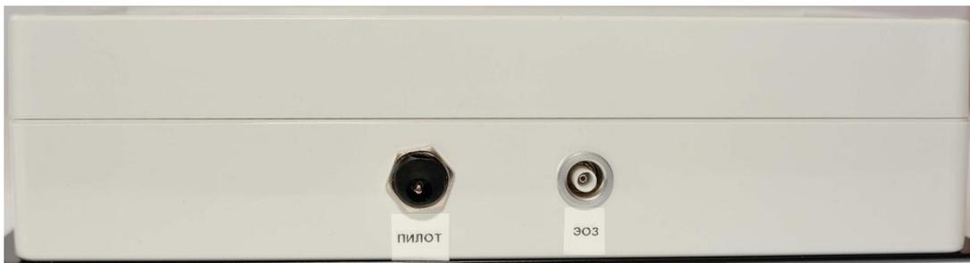
Рисунок 8 – Разъемы подключения ЭОЗ и лазера-пилота
