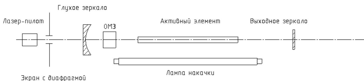
Рисунок 13 – Оптическая схема резонатора с оптикомеханическим затвором
