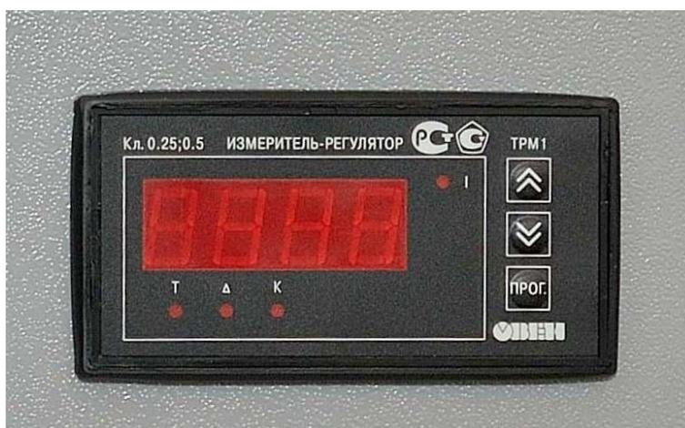
Рисунок 7 – Внешний вид измерителя-регулятора
