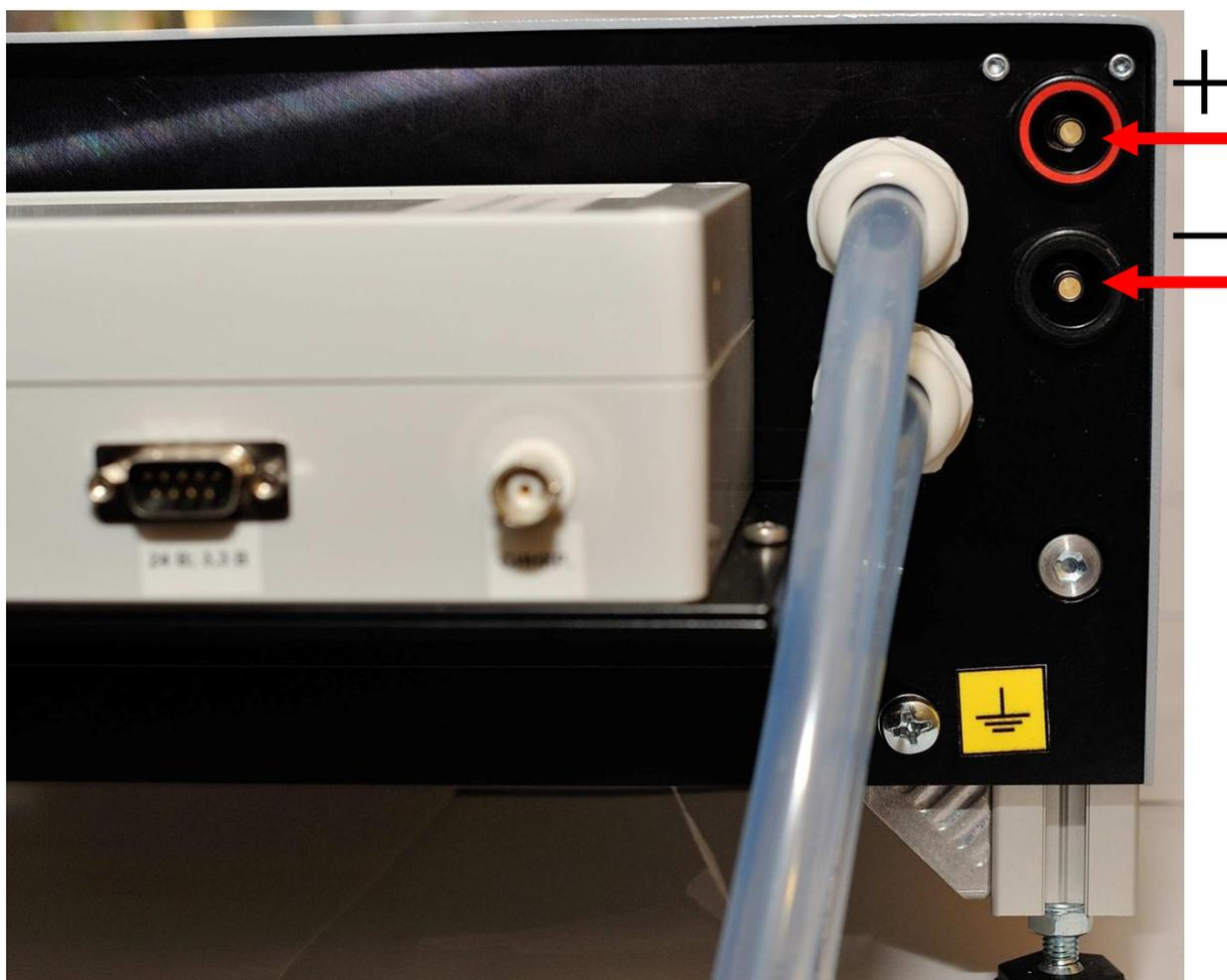
Рисунок 2 – Соединение излучателя с системой охлаждения и источником питания
