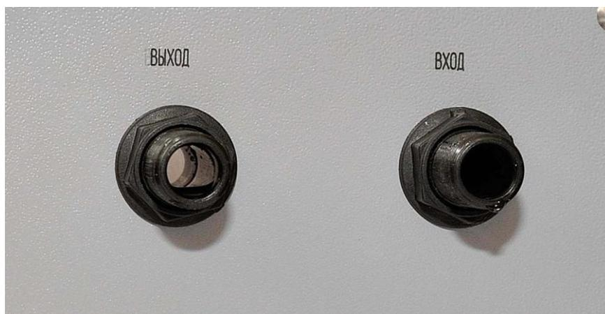
Рисунок 5 – Входной и выходной штуцеры системы охлаждения
