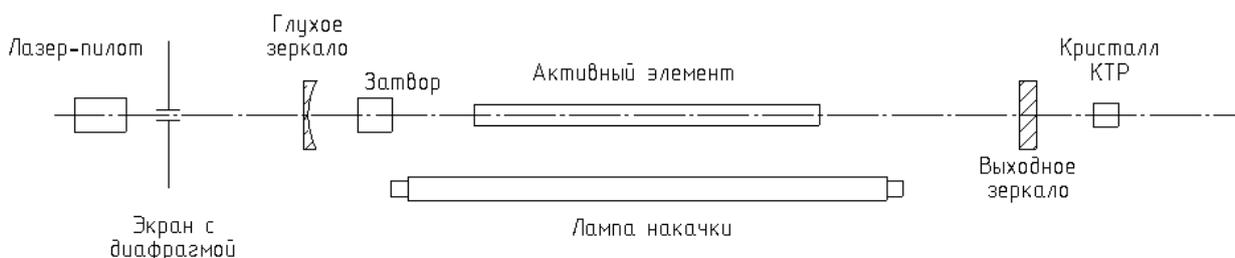
Рисунок 15 – Схема внерезонаторной генерации излучения второй гармоники
