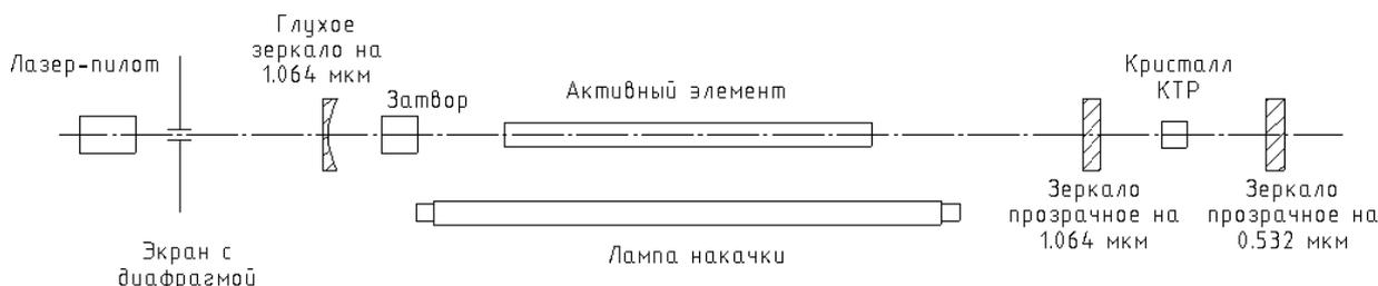
Рисунок 16 – Схема внутррезонаторной генерации излучения второй гармоники
