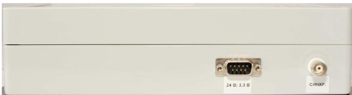
Рисунок 4 – Расположение разъемов питания и синхронизации блока управления затвором
