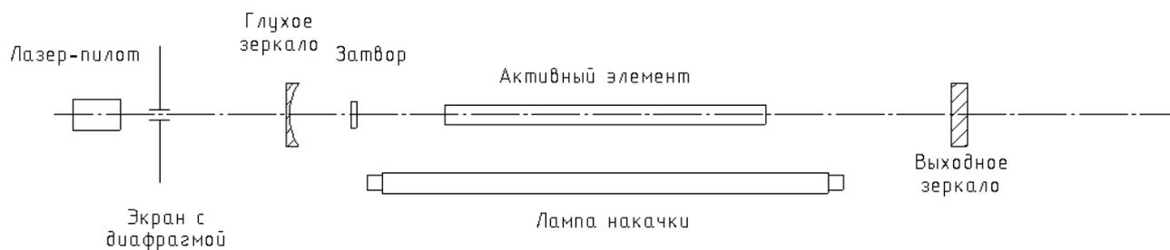
Рисунок 14 – Оптическая схема резонатора с пассивным затвором
