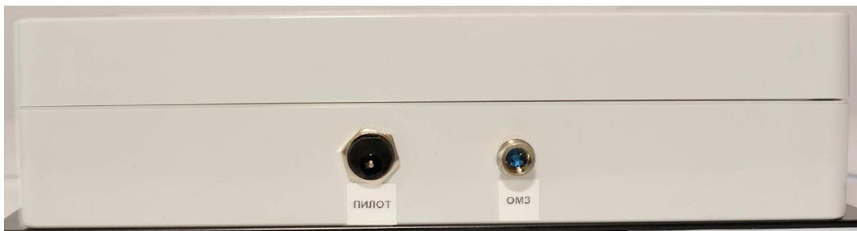
Рисунок 12 – Разъемы подключения ОМЗ и лазера-пилота
