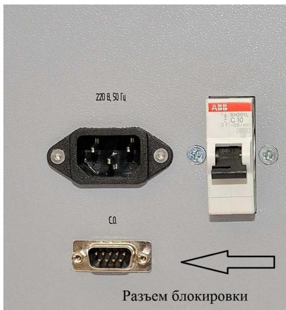
Рисунок 6 – Расположение разъема блокировки
