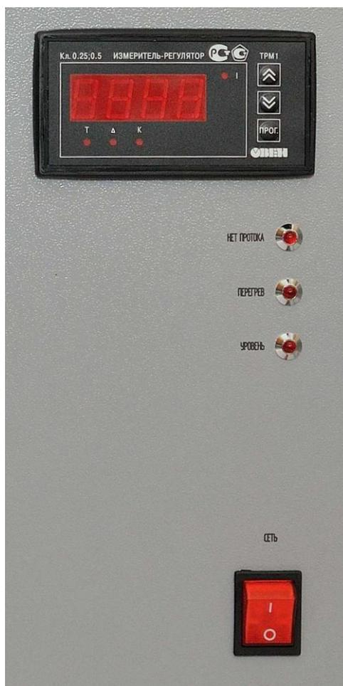
Рисунок 3 – Органы управления и индикации системы охлаждения
